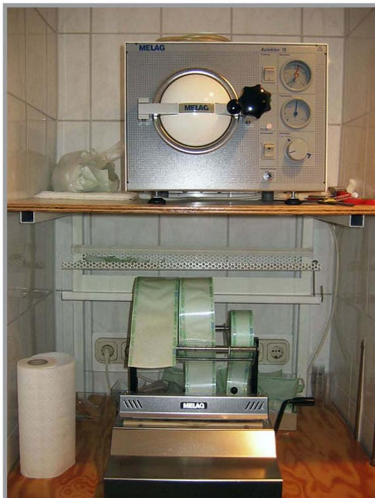
oben: Autoklav (Sterilisator) unten: Einschweißgerät
