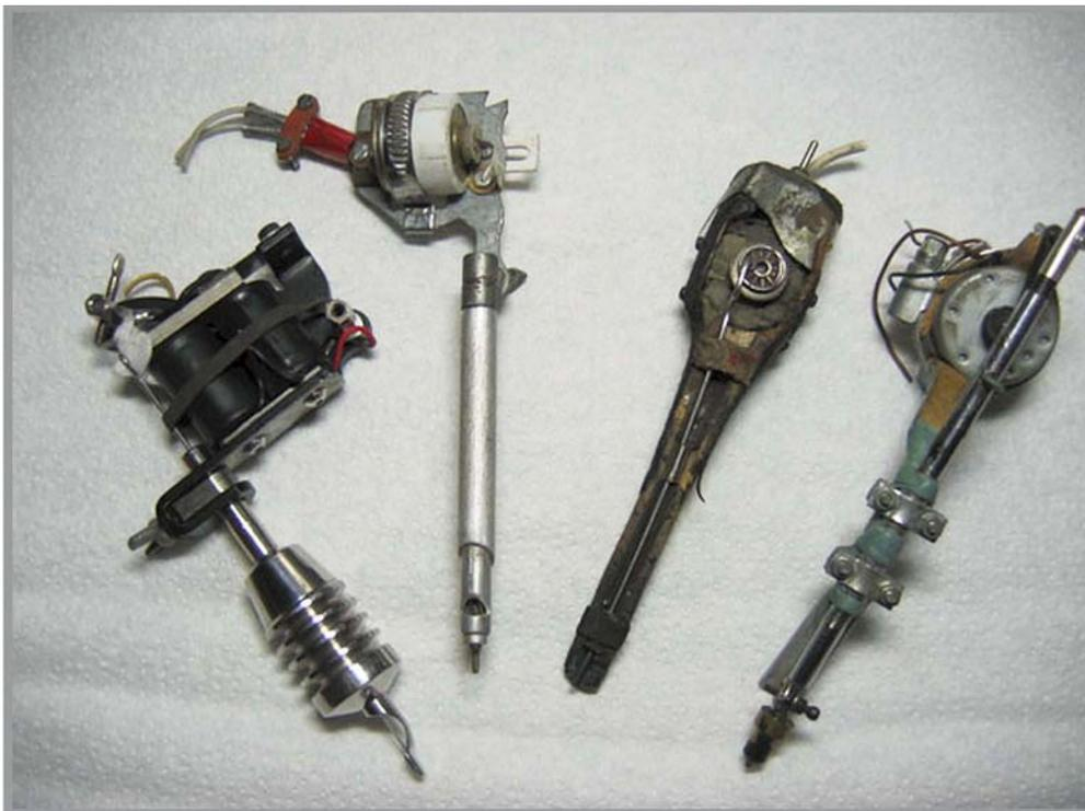
vlnr: Profi-Tätowiermaschine. drei selbst gebaute Maschinen mit Kassettenrekordermotor
